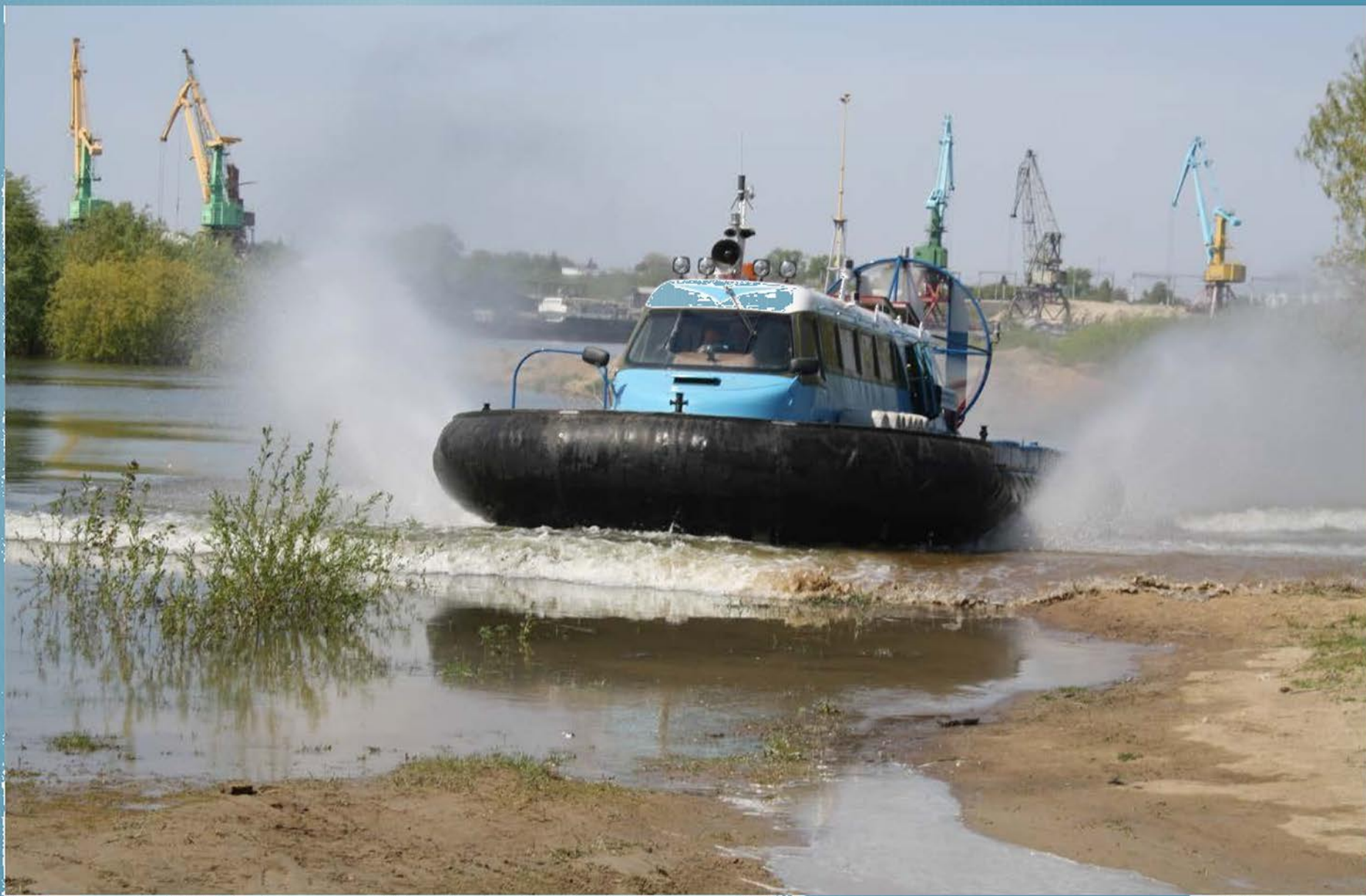
«Арктика-2Д» преодоление заболоченных участков местности с максимальной загрузкой 2000 кг
