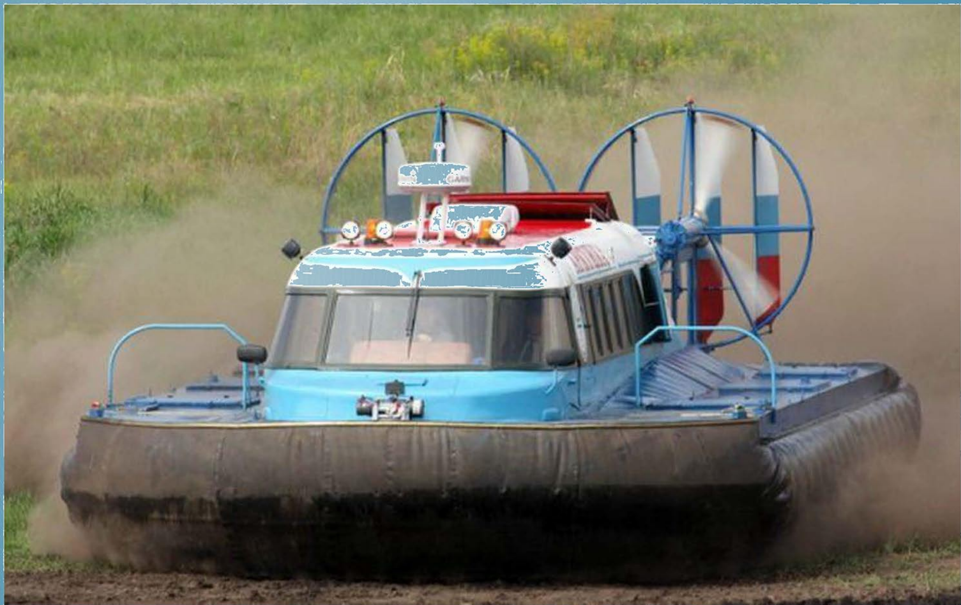
«Арктика-3Д» грузопассажирская. Испытания на пересеченной местности.
