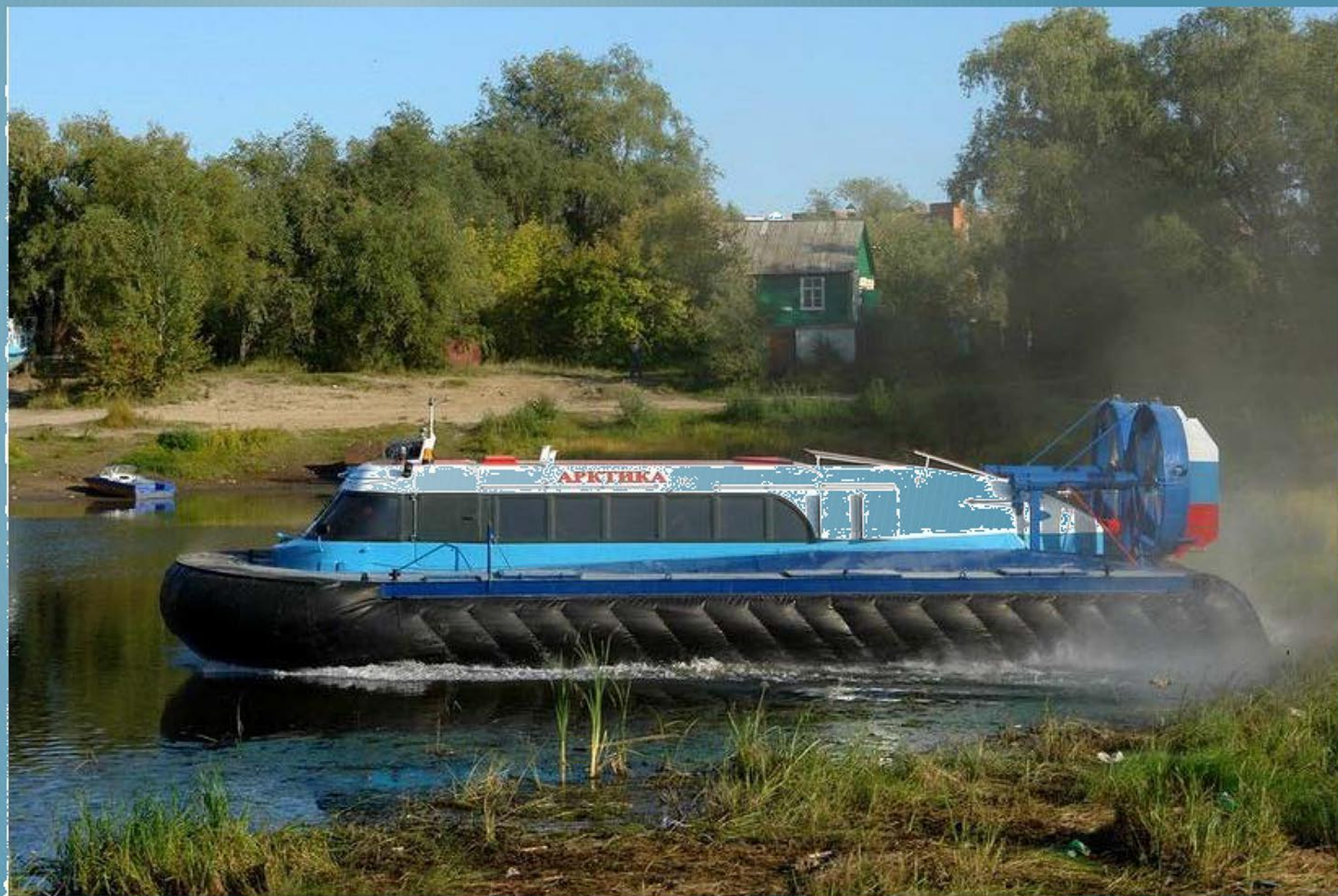
«Арктика-3Д» на полигоне в пойме р. Иртыш. Испытания на маневренность.
